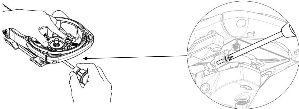
그라인더 휠 가드 설치부에 허리케인을 설치하고, 왼쪽의 그림과 같이 커넥터부를 누르면서 커넥터부착 나사를 확실히 체결합니다.
